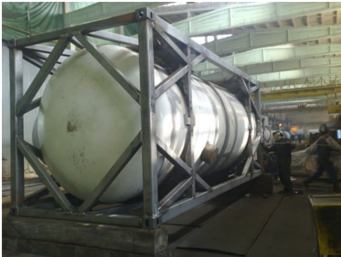
Cysterna LNG dla Wałbrzycha w trakcie produkcji, źródło: mech.pk.edu.pl
