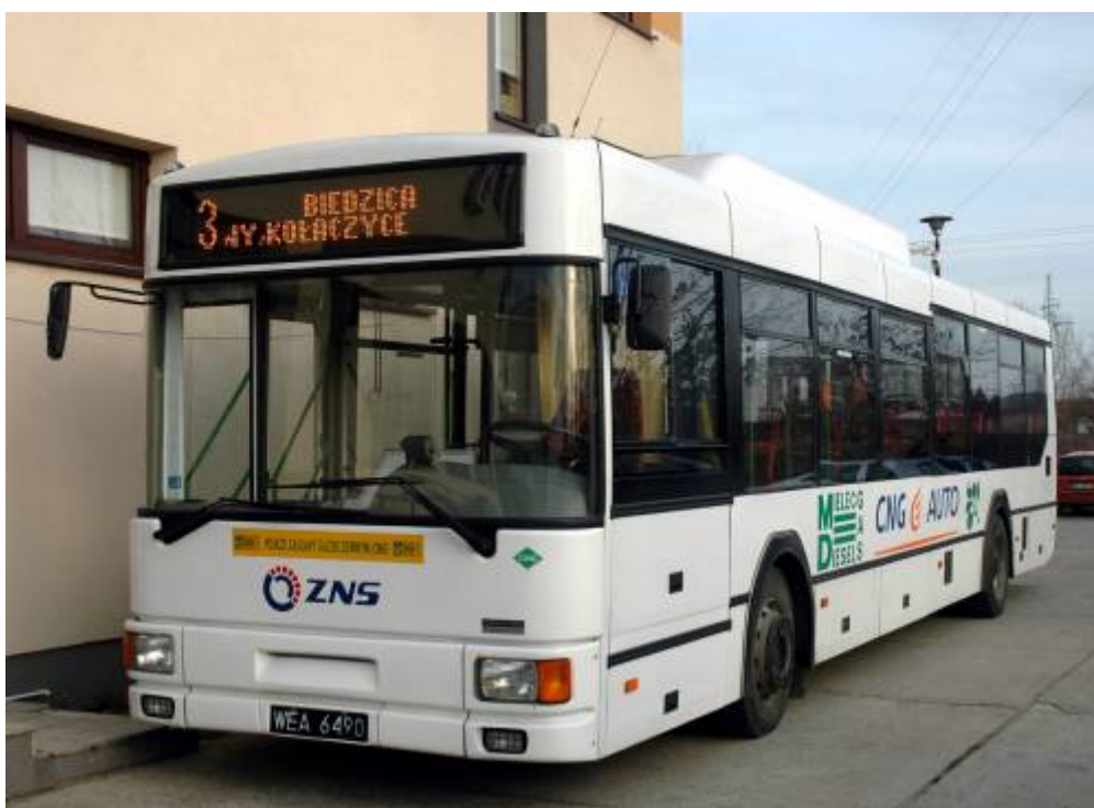
Jelcz M121 — adaptacja niskowejściowego autobusu z butlami kompozytowymi montowanymi na dachu. Gazeo.pl.
