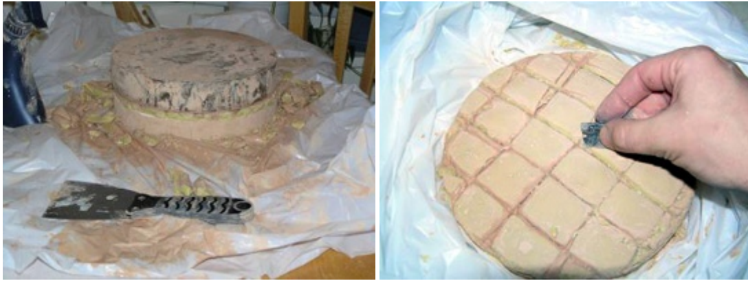
Rycina 33. Nadmiar lepiku zostaje odłupany szpachlą, następnie należy wyczyścić i poszerzyć rowki za pomocą żyłki. Dodatkowo należy ściąć krawędź polerownika pod kątem 45°.
