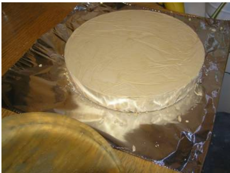
Rycina 27. Świeżo uformowana podstawa polerownika. Jej ostre krawędzie można złagodzić osetką. Linie na powierzchni to odcisk od zagiętej folii plastikowej, których nie trzeba koniecznie usuwać.
