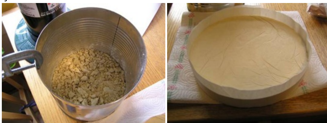
Rycina 28. Po lewej lepik burgundzki skruszony do puszki, po prawej podstawa z tamą z taśmy malarskiej. Do puszki przytwierdzone jest niewielkie imadło, aby utrzymać ją bez problemu, gdy lepik zostanie roztopiony i blacha się stanie się gorąca.
